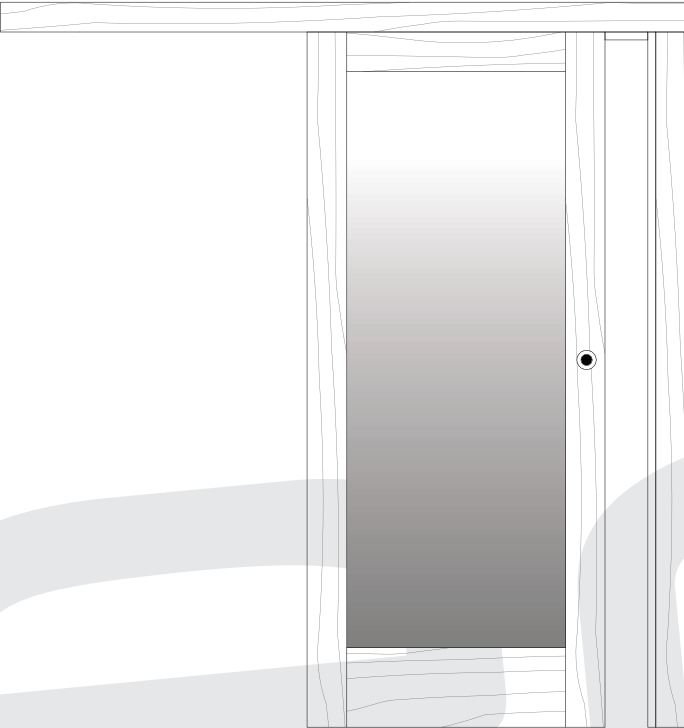
APERTURA SX (LATO MANTOVANA)
